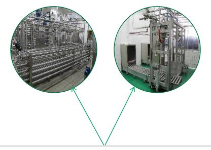
7条现代化生产线,UHT杀菌和无菌灌装生产线
